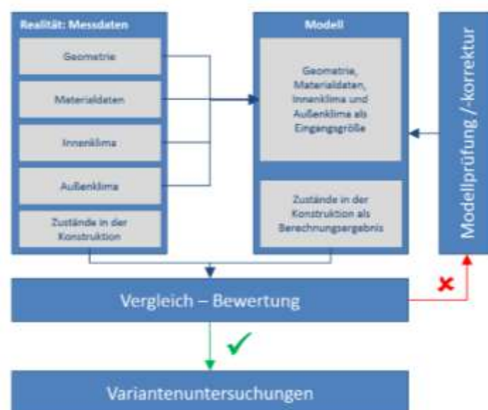
Abbildung 37 Prinzipieller Ansatz zur Modellierung und Modellkalibrierung
